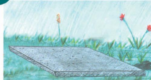
Será construida a base de concreto con dimensiones de 2.15 metros de ancho X 2.15 metros de largo X 20 centímetros de grueso, debe esperarse no menos de 11 días para poder colocar el tinaco, utilizando:
